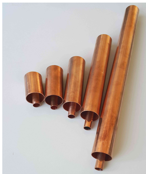
Rysunek 4: Zestaw współosiowych linii transmisyjnych zaprojektowany z wykorzystaniem podejścia [A1] i używane do kalibracji systemu pomiarowego przedstawionego w [A4], [B4].
